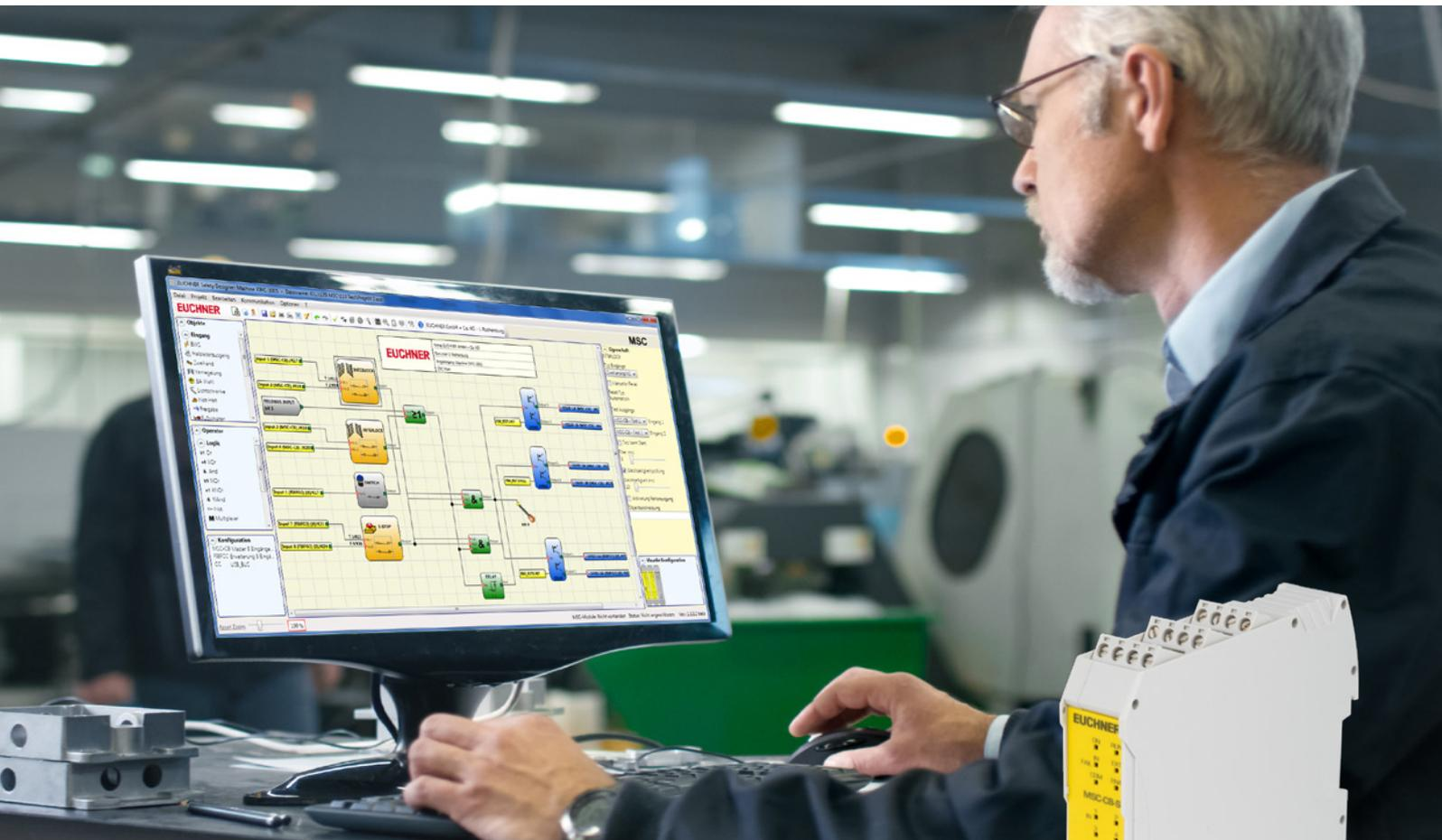
Le logiciel « EUCHER Safety Designer » permet de configurer, de programmer et de documenter le système de sécurité MSC. De l'utilisation aisée de l'interface graphique à la création d'un rapport de projet en passant par les possibilités de diagnostic, le logiciel aide à une mise en service rapide.
