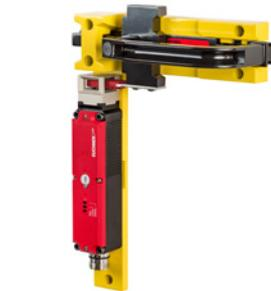
Grazie ai fori di montaggio presenti, i chiavistelli possono venir installati sui ripari di protezione in modo facile e veloce. Particolarmente agevole risulta il montaggio su profilati standard in alluminio. I chiavistelli si possono combinare sia con i finecorsa di sicurezza elettromeccanici sia con quelli senza contatto.
