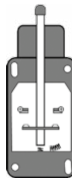
Abb. 10 Positionsschalter, Prinzip der Zwangsöffnung
